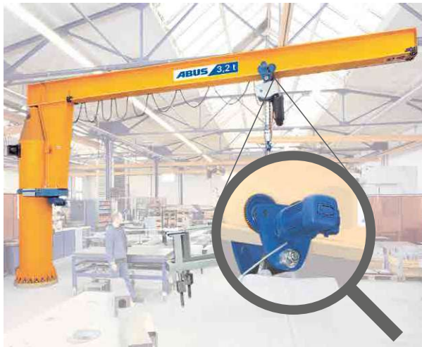
Traslación eléctrica del carro (fig. 1)
